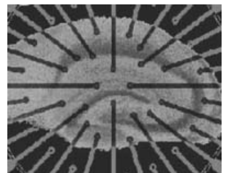
Draufsicht auf ein 40 Elektroden-MEA
